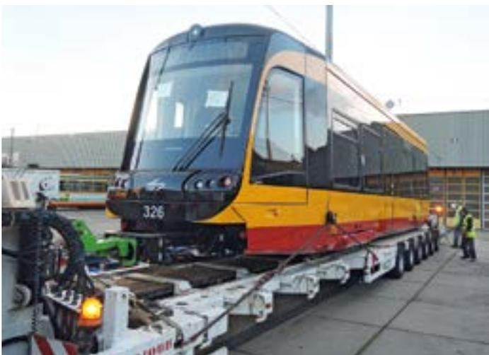
**Aufgrund der räumlichen Distanz** erfolgt der Transport nach Karlsruhe aus einer Kombination von See- und Landweg. Das Fahrzeug wird zweigeteilt auf spezielle Tieflader geladen. In Karlsruhe angekommen beginnt die Phase der Inbetriebnahme. Hier werden die restlichen Prüfungen, letzte Änderungen und Anpassungen vorgenommen – das Fahrzeug wird für den Einsatz im Fahrgastbetrieb fit gemacht.
